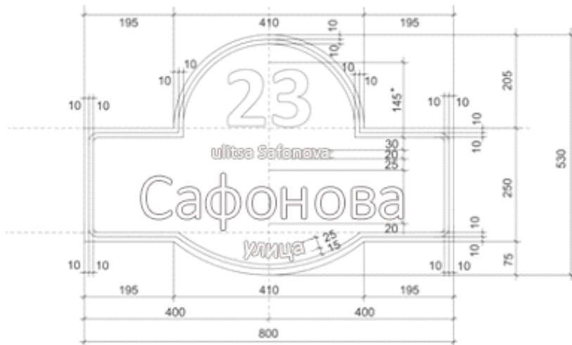
3.2. Тип адресного указателя № 2 предназначен для размещения на всех остальных объектах адресации. Номер объекта адресации пишется в нижней части указателя, выравнивается по центральной вертикальной оси. Поле для написания наименования и вида элемента улично-дорожной сети располагается в центральной части верхней половины указателя. Наименование элемента улично-дорожной сети выравнивается по центральной вертикальной оси.
