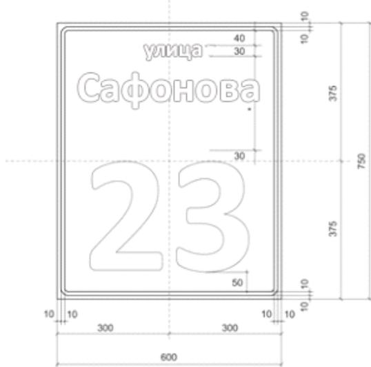
3.3. Тип адресного указателя № 2 в уменьшенных габаритах предназначен для размещения в случае технической невозможности размещения адресного указателя типа № 2.
