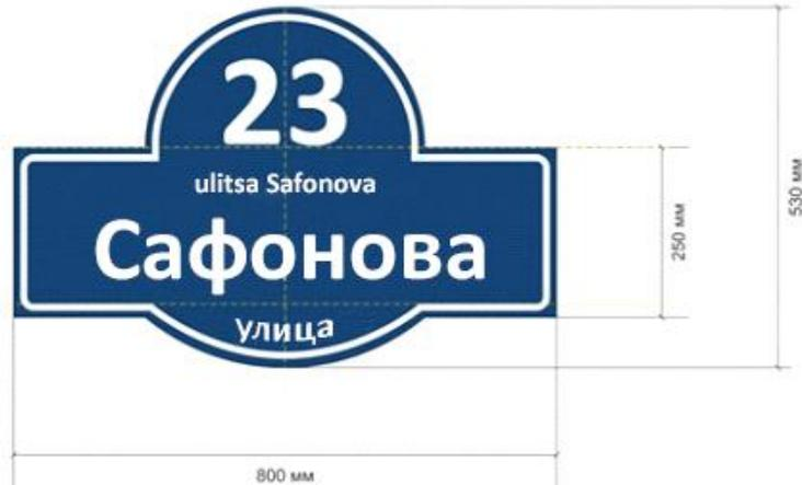
Габаритные размеры адресного указателя (мм)
