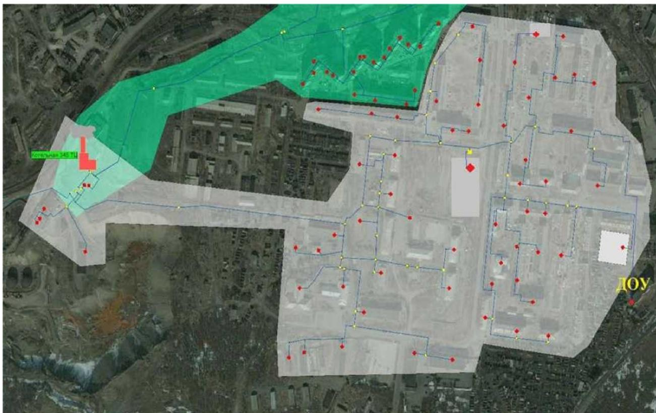
**Рисунок 1.1.2. Схема тепловых сетей при подключении перспективного потребителя к котельной 345 ТЦ.**
