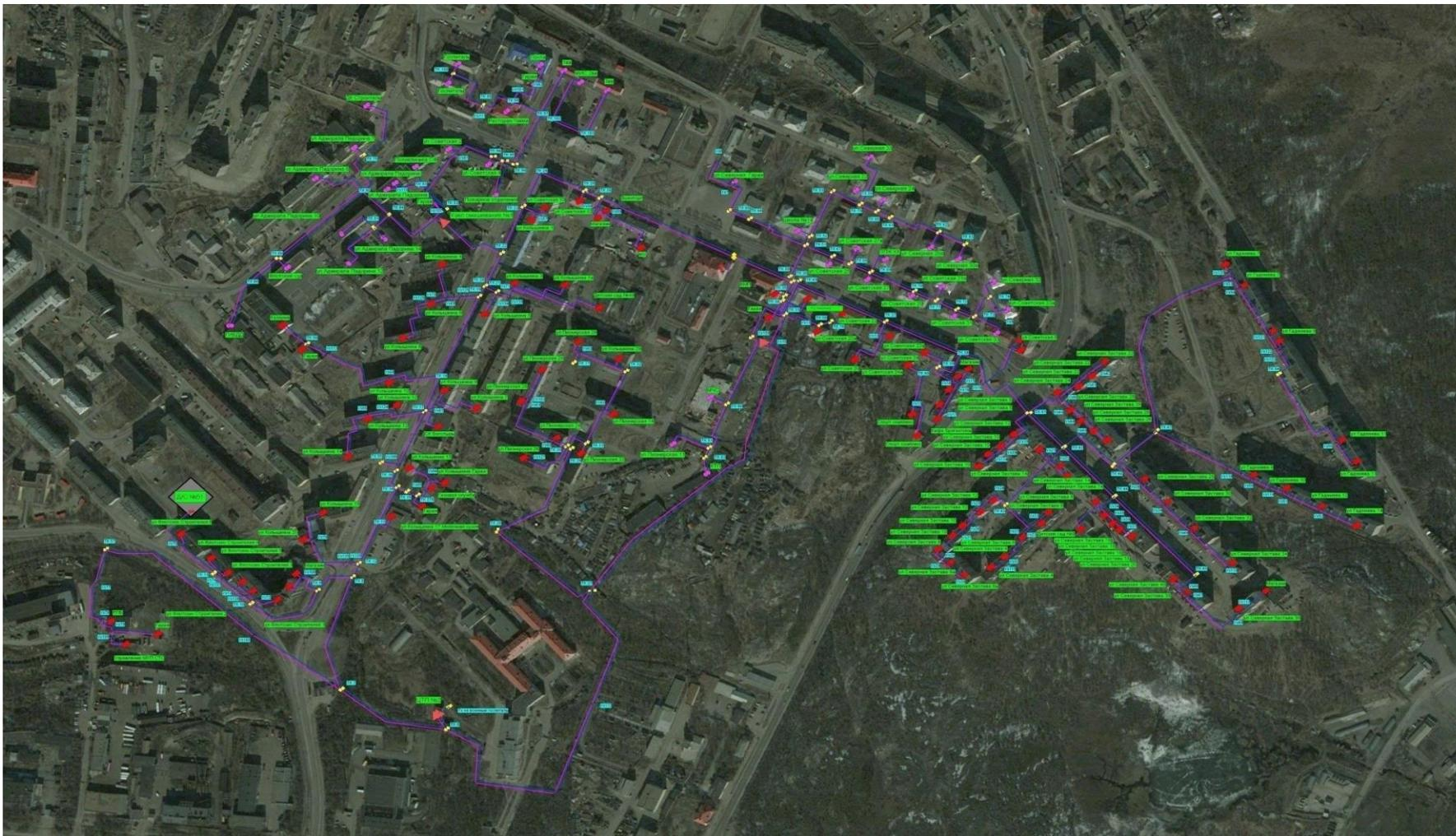
Рисунок 1.3.2.1. Схема тепловых сетей от ТЦ 345 «Верхняя Ваенга»
