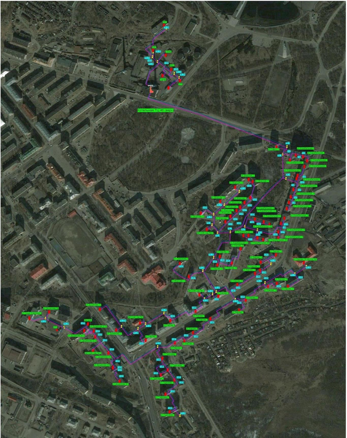
Рисунок 1.3.2.5. Схема тепловых сетей от ТЦ 46 «Верх» города
