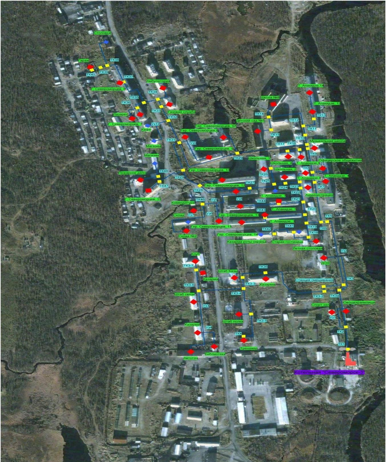
Рисунок 1.3.2.8.Схема тепловых сетей от котельной 452 ТЦ «Североморск-3»
